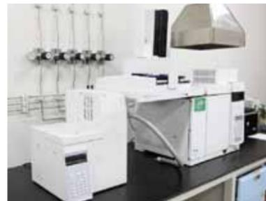
色谱类检测仪可完成对有害物质的检测，以及对产品中关键成分（绿蜂胶中阿特匹林C、鱼油中DHA和EPA等）的含量测定。
